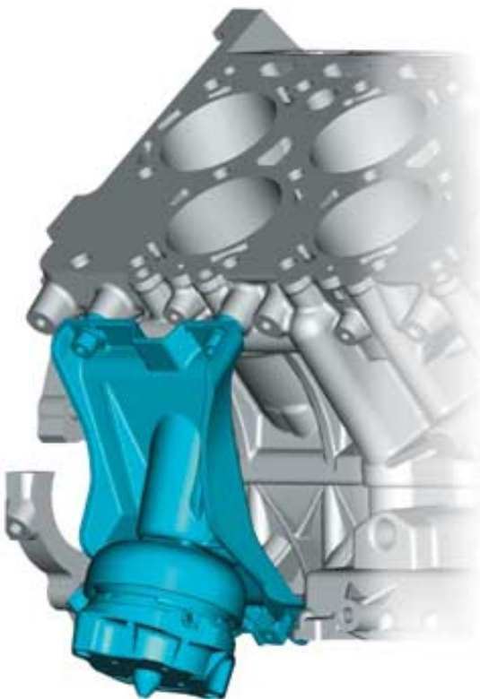
Motorlager Zylinderbank 1 mit Magnetventil N145
