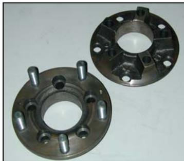
Zur Montage der getopften Bremscheiben ist der **MBT**-Radnabenadapter notwendig, welcher die Tiefe des Topfes überbrückt. Auch diese Teile sind aus hochwertigem Sphärroguss. Sie werden auf die originale Radnabe geschraubt und dienen so als Aufnahme für die Bremscheiben.
