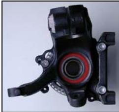
Die Porsche-Bremszangen der 'neueren' (993, 996) und der einiger Sondertypen werden nicht wie die originalen VW- und Audi -Bremsen axial (in Richtung der Antriebswelle) sondern radial (senkrecht zur Raddrehachse) befestigt. Dieser konstruktiver Unterschied macht den Einsatz von Adaptern notwendig.
