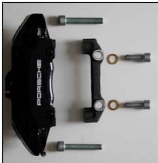
Empfehlenswert für den Einsatz in diesen Fahrzeugen sind insbesondere die Bremssysteme oder Komponenten der neueren Typen 968S, 964, 993, 996. Die verwendeten Vierkolbenfestsattel-Bremsszangen sind mit *radialen* Befestigungsaufnahmen ausgeführt. Das heißt, die Bremsszangen werden aufgrund ihrer Bauform senkrecht zum Achszapfen (radial) einfach mit den **MBT-Adaptern** montiert.
