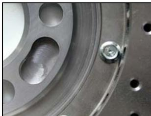
Für spezielle Anwendungen können auch Bremsscheiben in der Dimension 299/28 und 322/28 eingesetzt werden. Die Handbremsmechanik basiert auf der „Euro-Handbremse“ mit Großserienteilen .
