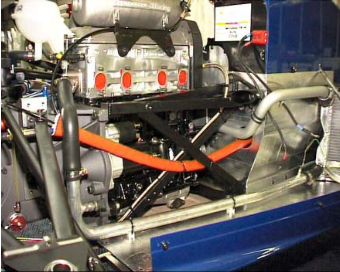
Verlegung Schaltzug, Gaszug, Sperrenzug in Hitzeschutzschlauch (l=750mm)
