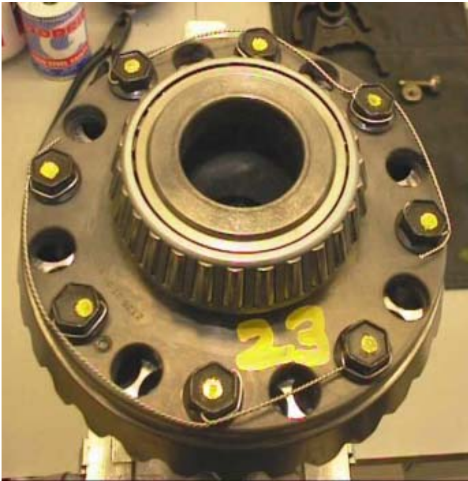
Schrauben Tellerrad mit Draht gesichert
