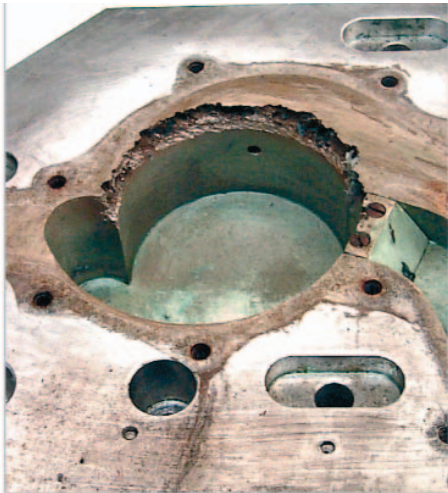
Erosione su attrezzatura di prova / Erosion on test equipment
